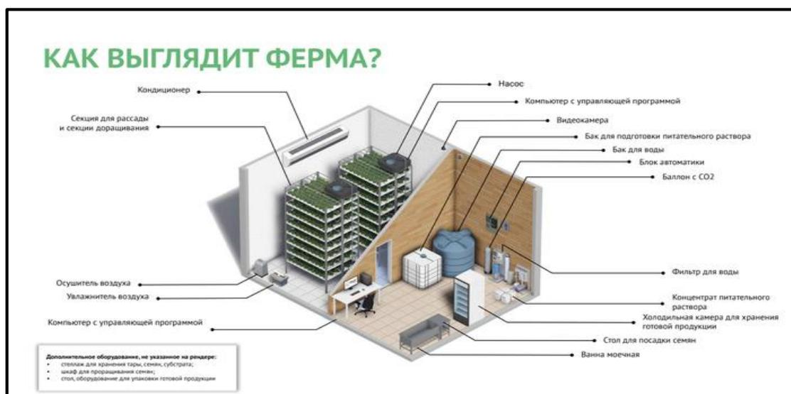
Рисунок 2 – Устройство вертикальной фермы [5]
